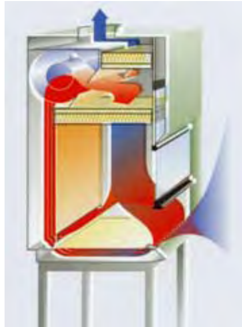
Abb. 4: Luftführung in einer Sicherheitswerkbank der Klasse 2.
