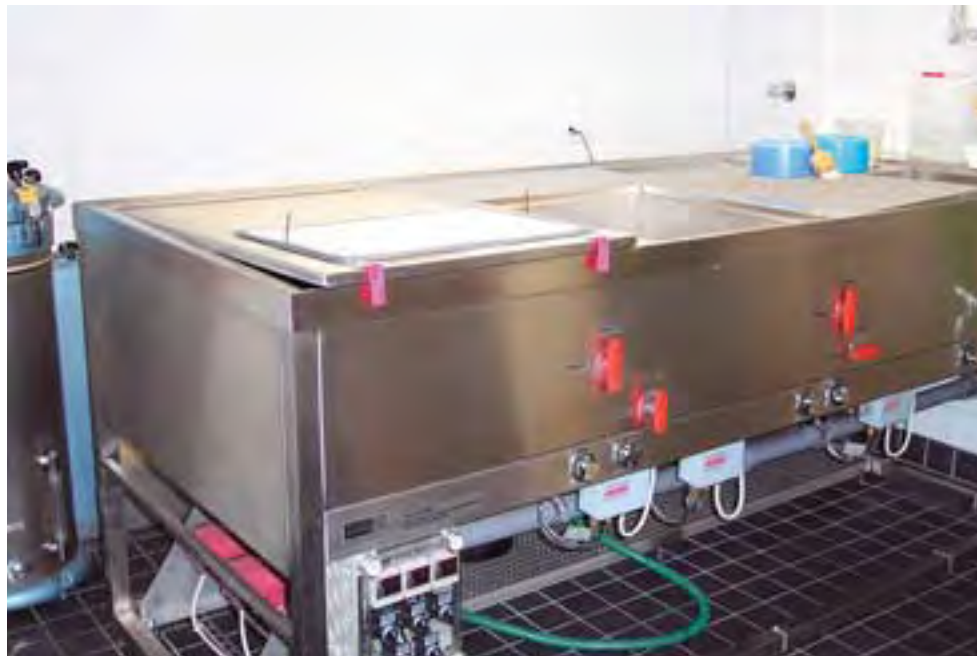
Foto 8: Das Wässerungsbecken dient der Nassreinigung von Papier.
