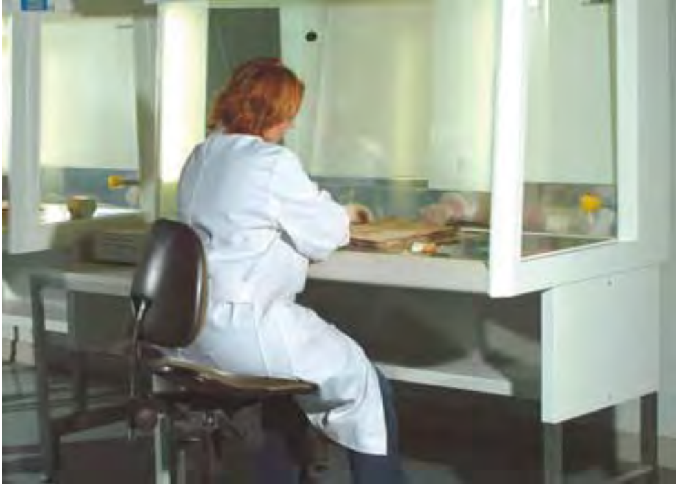
Foto 7: Trockenreinigung unter einer Sicherheitswerkbank.
