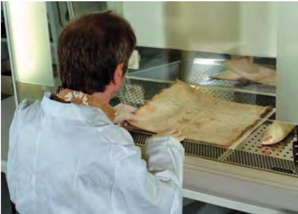
Foto 11: Die Trockenreinigung wird unter einer mikrobiologischen Sicherheitswerkbank durchgeführt.
